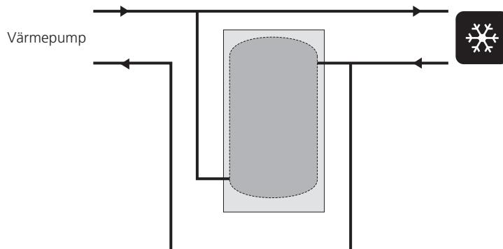
I de fall då systemvolymen i klimatsystemet är under min. rekommenderad volym för värmepumpen och/eller flödet stryps okontrollerat installeras en UKV-tank som volym- och flödesförhöjare.
