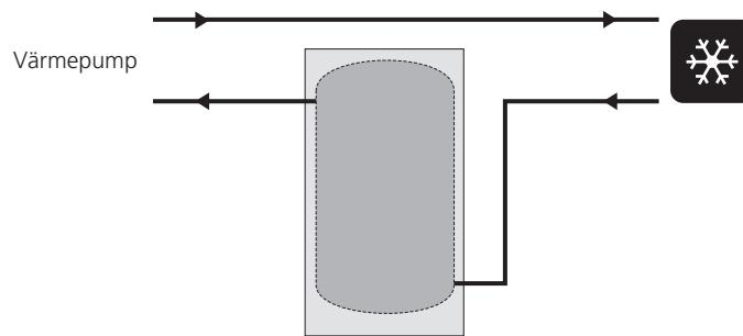
I de fall då systemvolymen i klimatsystemet är under min. rekommenderad volym för värmepumpen och/eller flödet stryps okontrollerat installeras en UKV-tank som volymförhöjare.
