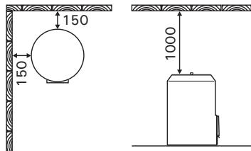
**Lattian suojaaminen (min. mm)**
