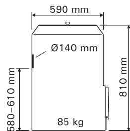
**Säätöjalat (3 kpl):** Nosta pataa n. 50 mm, jonka jälkeen säätöjalan ruuviosa laitetaan muoviosassa olevaan reikään. Laita pata paikoilleen ja säädä se vaakatasoon säätöruuvin avulla.
