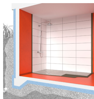
BILD B – Källare utan tillskjutande markfukt
