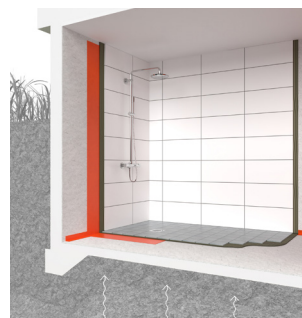
BILD A – Källare med tillskjutande markfukt
