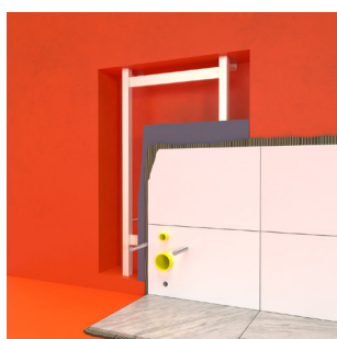
BILD P – Tätskikt bakom inbyggd WC i vägg Tätskikt ska finnas under och bakom den inbyggda spolcisternen. Eventuellt läckage vid armatyren ska rinna ut till våtrummet.
