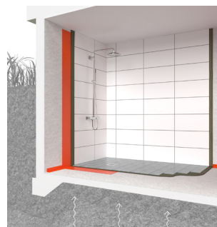
BILD A – Källare med tillskjutande markfukt
