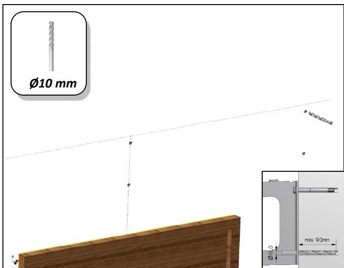
**DK:** Bor derefter hullerne op med et Ø10 mm mur bor, til medfølgende ekspansions bolte (P05). Min. 90 mm. Boltene til fastgørelse kan kun bruges til beton og massive murstens vægge. Hvis udhængen skal hænges op på andet underlag skal anden befæstigelse anskaffes.
