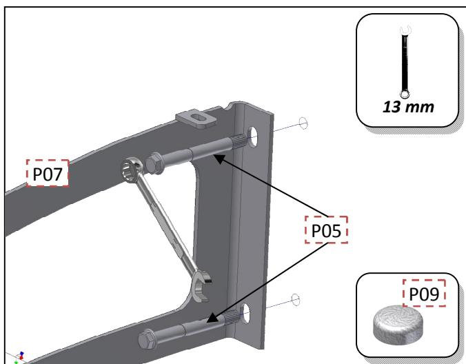
**DK:** Hold derefter knægtene op til de børed huller og indsæt ekspansionsboltene i hullerne. Spænd derefter ekspansionsboltene, til knægten hænger fast. Boltene spændes med en 13mm nøgle. På sæt derefter de medfølgende grå bolthætter(P09).
