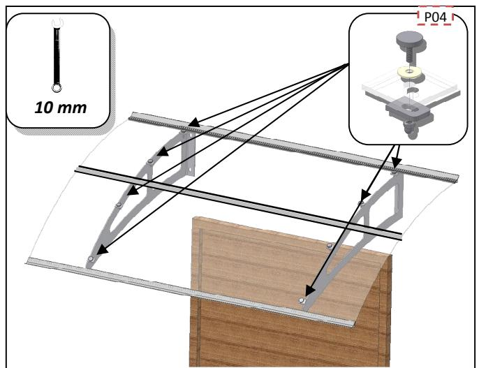
**DK:** Læg derefter polycarbonat pladen op og monterer derefter de medfølgende M6x15 mm(P04) møtrikker/bolte. Skiven skal ligge oven på pladen, spænd efter med 10 mm nøgle.
