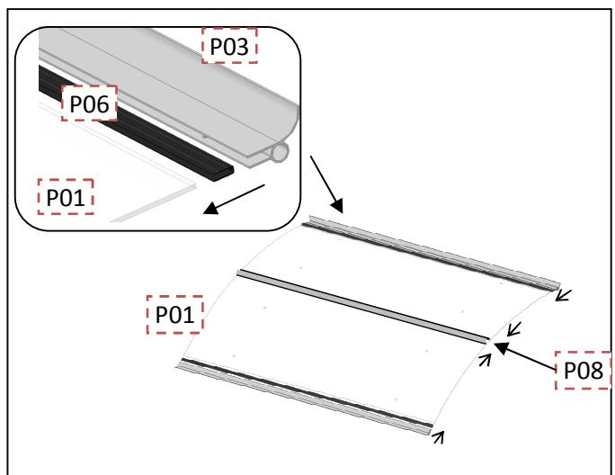
**DK:** Træk beskyttelses filmen af polycarbonat(P01) pladerne på begge sider (Læg IKKE pladen ned uden at beskytte den). Før monteringen af gummilisterne (P06), put listen i varmt sæbevand i ca. 1 min. Dette gør isætningen nemmere, og efterfølgende monter de medfølgende aluminiumslistre (P03).
