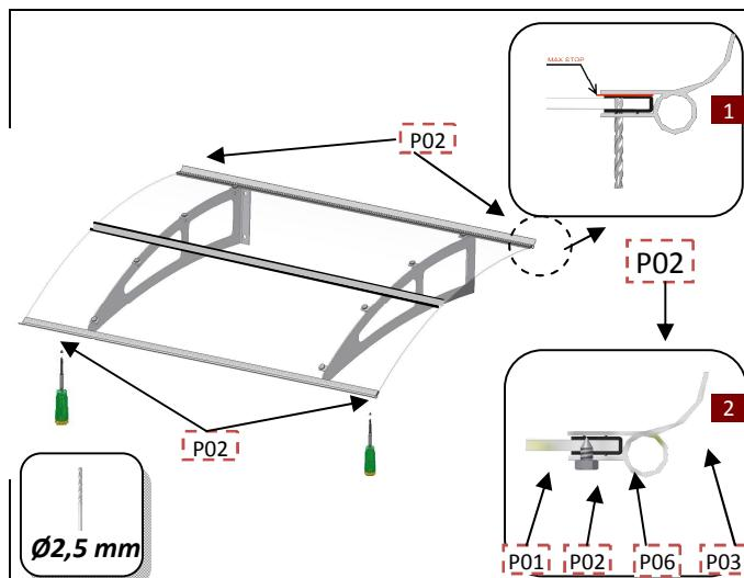
**DK:** Vend derefter polycarbonat pladen. VIGTIGT: Efter montering af gummilister(P06) og aluminiumslister(P03), bør med Ø2,5mm bør i de forbored huller, MEN kun i gummilisten(P06) og polycarbonat-pladen(P01). IKKE I ALUMINIUMS-LISTEN. Bor KUN 5 mm ned (IKKE HELT IGENNEM). Derefter monteres de små medfølgende skruer(P02).
